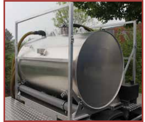
Stelaż do mocowania toalety/ Słupki ochronne
