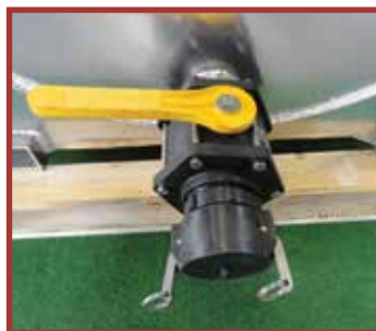
3-calowy spust nieczystości z korkiem
