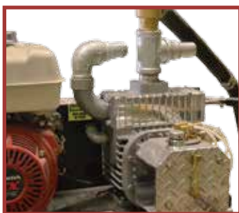
Zawór próżnia-ciśnienie do pompy próżniowej Conde
