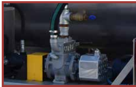
Układ próżniowy z pompą Conde
