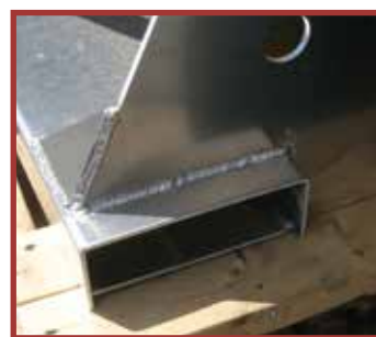
Miejsca na wsunięcie widel wózka widłowego, ułatwiający przewożenie
