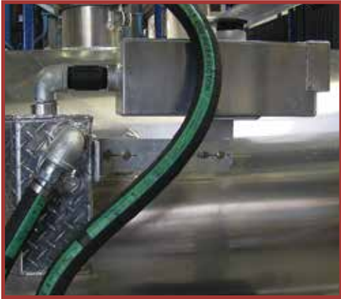
Pochłaniacz zapachów oparów wylotowych, połączony z tłumikiem
